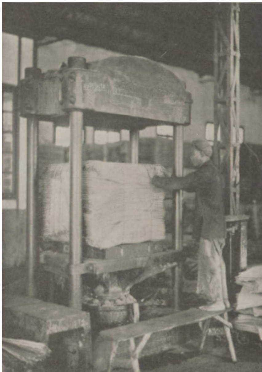
Compression des cartons à la presse hydraulique à Vietri
